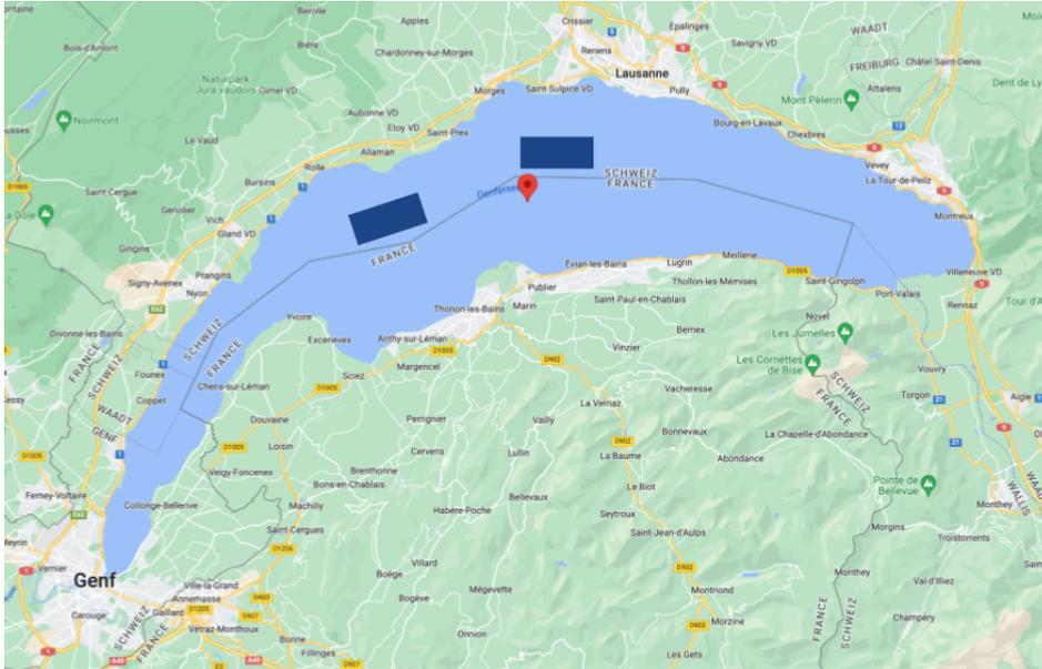
Für eine Jahresproduktion von 15 TWh würden insgesamt ca. 85 km<sup>2</sup> Seeflächen benötigt. In der Visualisierung zwei Anlagen à je 10 km<sup>2</sup>. Zum Vergleich: der Schweizer Anteil der Fläche des Genfersees beträgt 345 km<sup>2</sup>, davon würden 5,8% mit schwimmenden Fotovoltaik-Modulen bedeckt, 94,2% blieben frei. (Kartendaten © 2022 Google)
